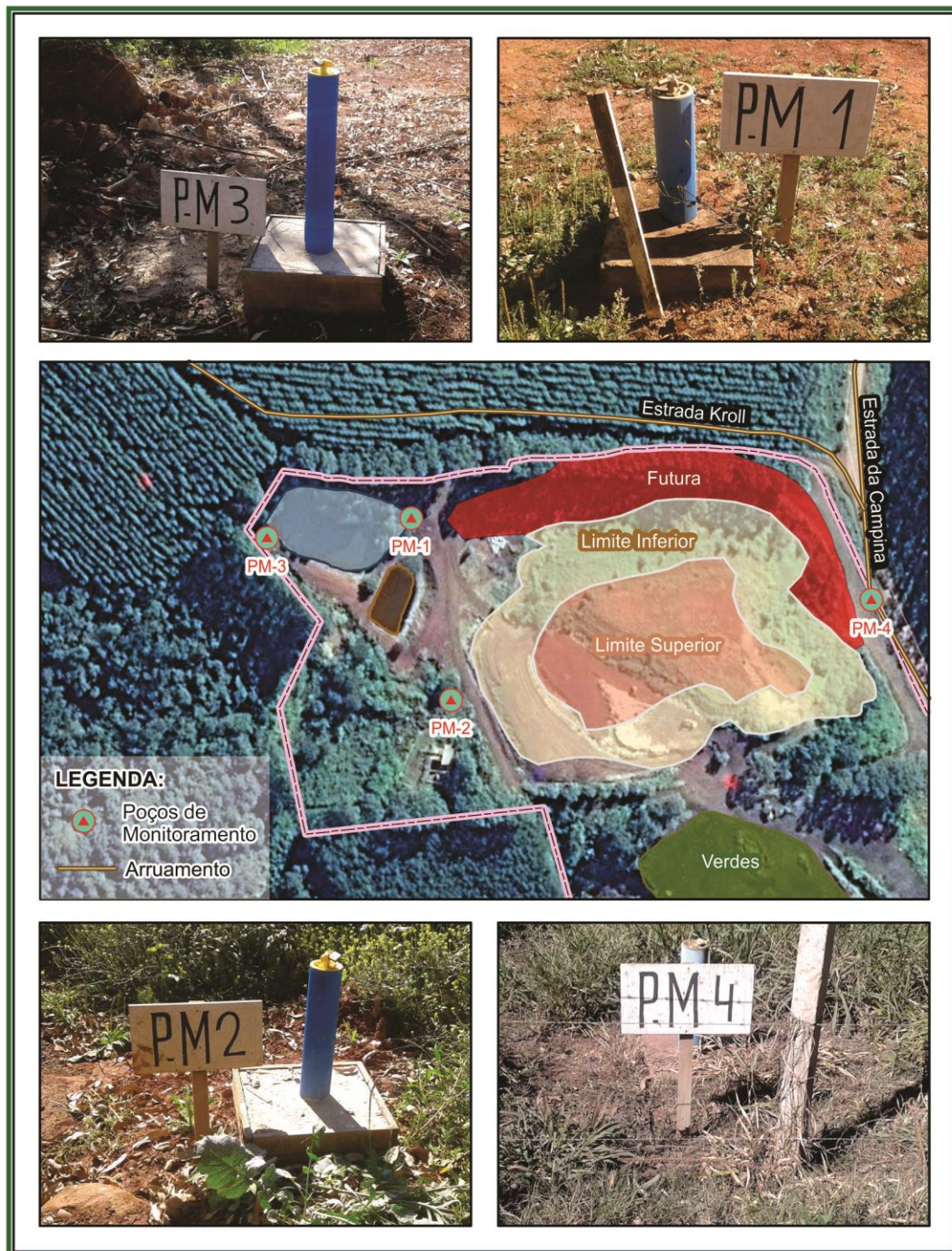
Figura 139: Poços de monitoramento do nível do lençol freático no aterro sanitário.
