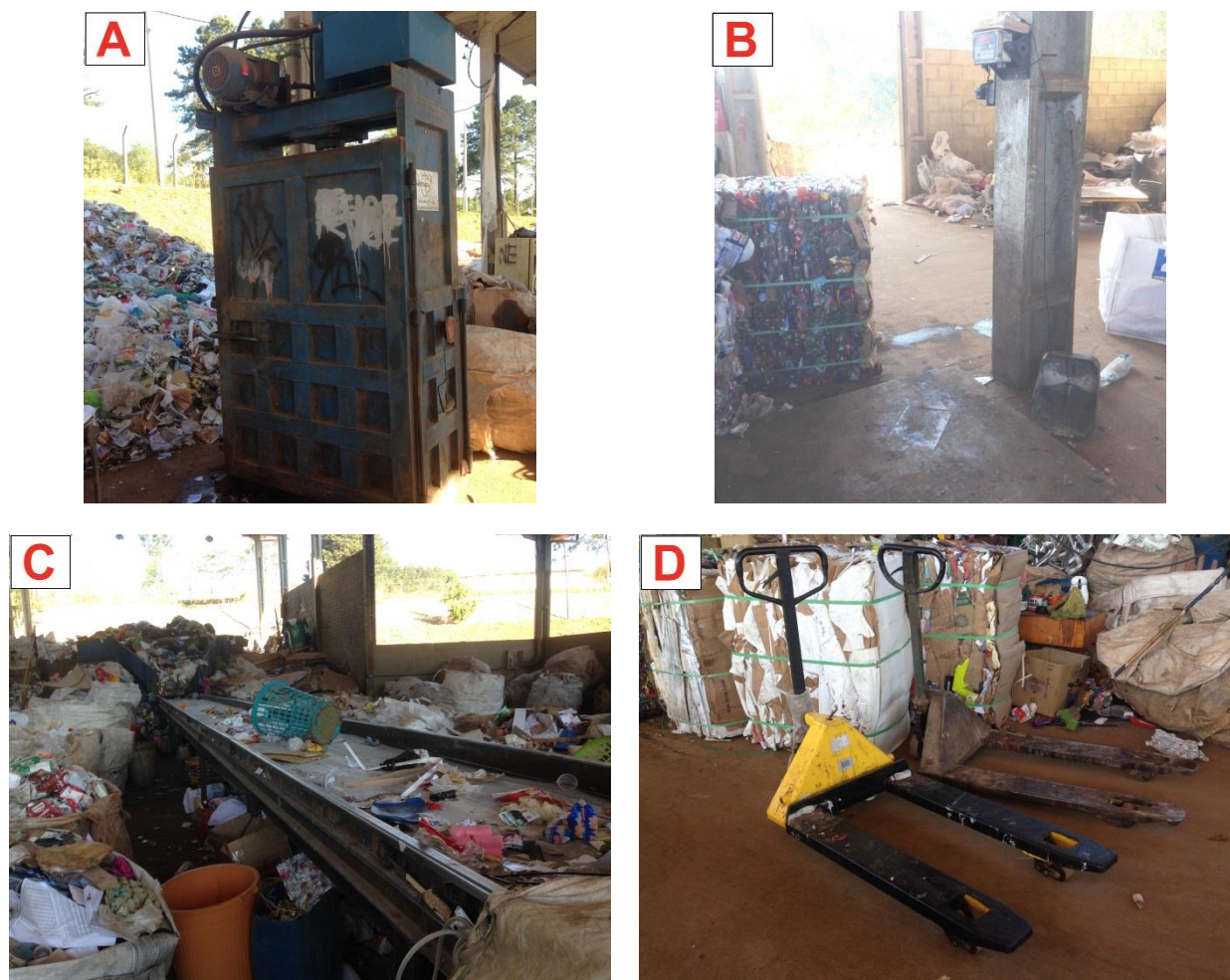
Figura 146: Equipamentos da Cooperativa Ambiental de Telêmaco Borba – Prensa hidráulica (A), balança (B), esteira (C) e carrinho para carregar material (D).
